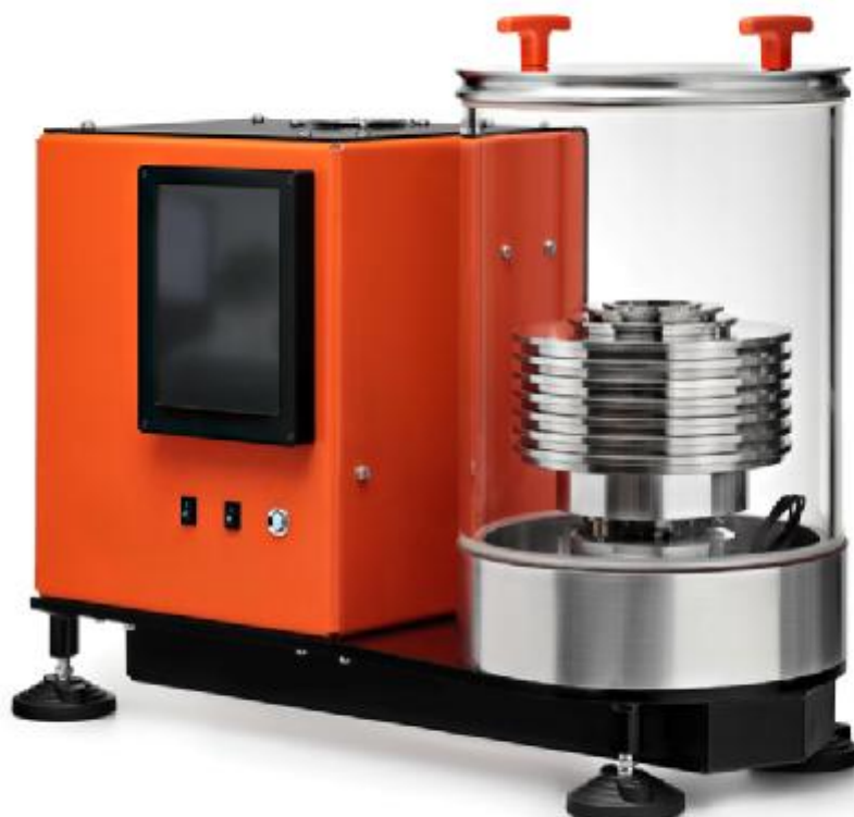
Рисунок 1 – Общий вид манометра грузопоршневого МПА
