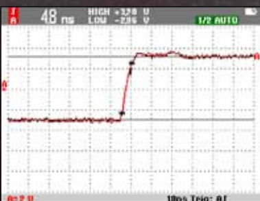
Частота дискретизации 5 Гвыб/с или разрешение дискретизации 200 пс обеспечивает детализацию, необходимую для проверки фронта сигнала dV/dt или признаков вредных отражений.
